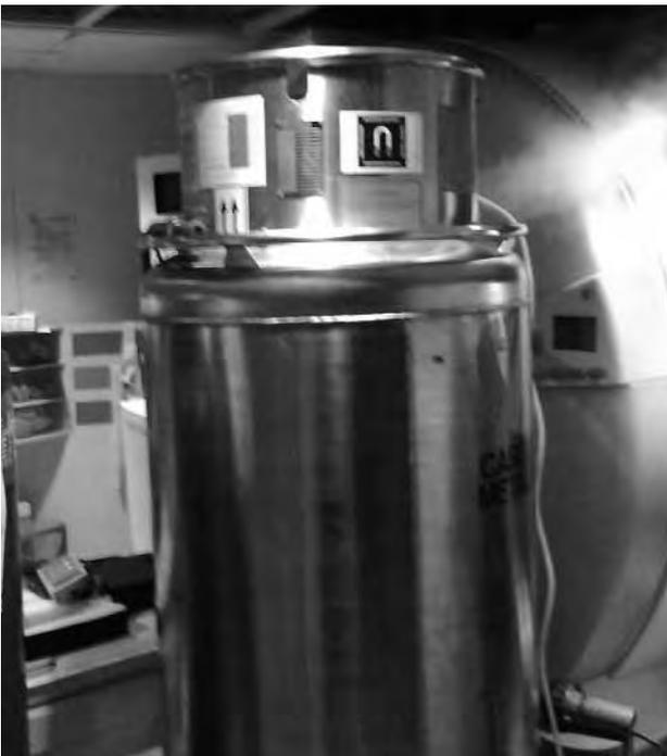
Fig.11. Reposición de Helio tras Quench
