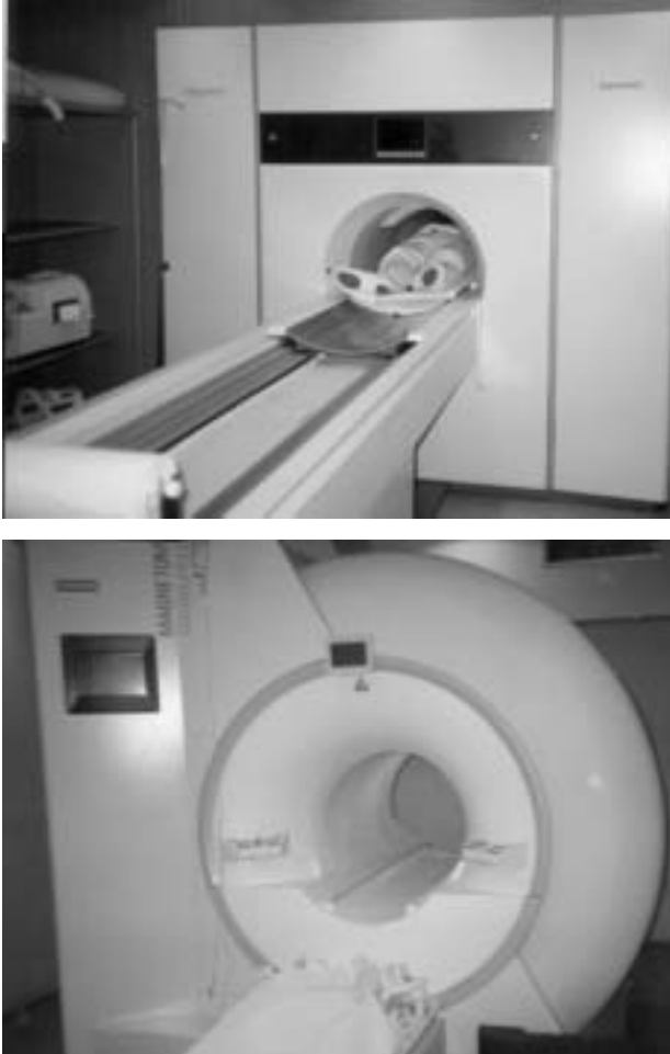
Fig.2 y 3 El diseño de los equipos de alto CM consiste en un tubo cilíndrico abierto por sólo un extremo o por los dos.
