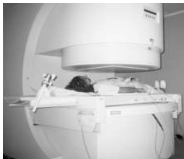
Fig.1 Imán resistivo de 0,2 T con un diseño abierto en forma de C.
