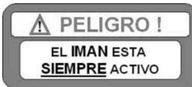
Fig.9 En los imanes superconductivos cuando el equipo está apagado la fuerza del imán sigue siendo la misma que cuando están encendidos. No ocurre lo mismo con los imanes resistivos.
