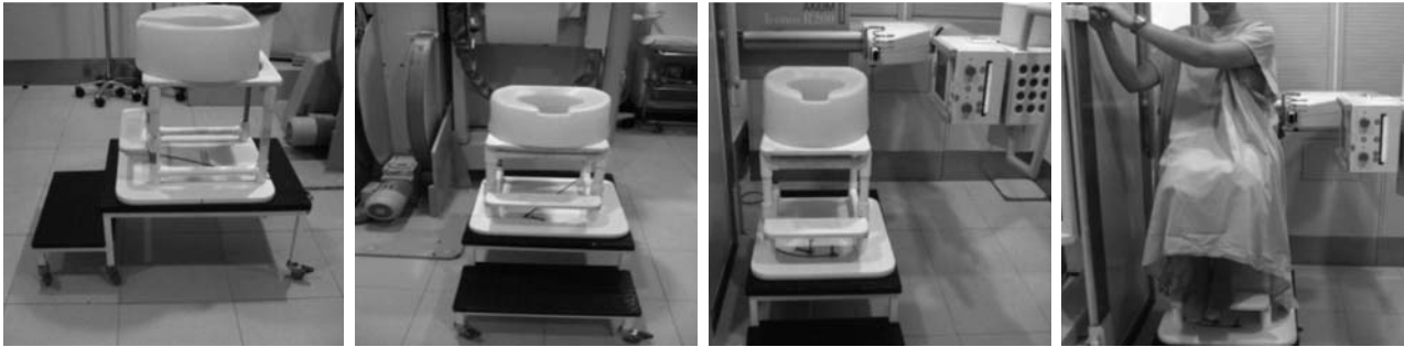
Silla Brunswick™ es un asiento radiotransparente formado por un recipiente ovoideo que se rellena de agua con el fin de disminuir la radiación difusa
