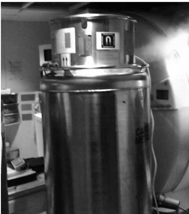
Fig.11. Reposición de Helio tras Quench
