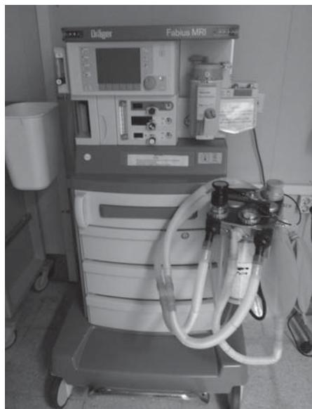
Foto 5. Respirador digital no ferromagnético.
